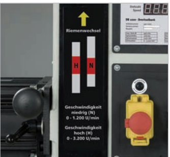
Variable Drehzahlregulierung von 0-1.200 (H) und 0-3.200 1/min. (L) in zwei Geschwindigkeitsstufen.
