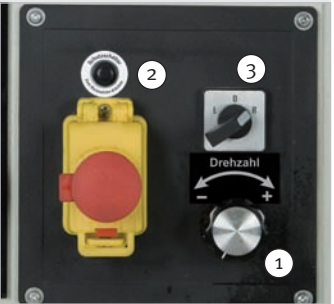
Variable Drehzahlregulierung von 0-1.200 (H) und 0-3.200 1/min. (L) in zwei Geschwindigkeitsstufen.
