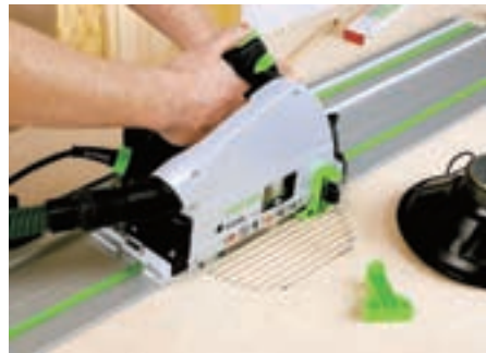
Beidseitig ausrissarm Sägen, dank Führungsschiene und aufsteckbarem Splitterschutz.
