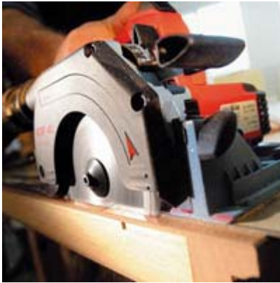
Optimale Handlichkeit und Schienenführung. Zwei Garanten für hohe Präzision, wie hier beim Ablängen von Zimmertüren.
