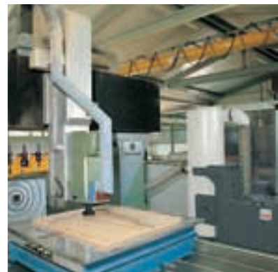
DUSTOVAC an einer CNC-Bearbeitungsmaschine
