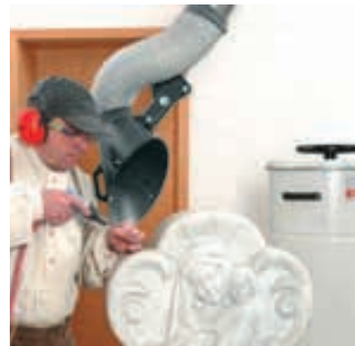
DUSTOMAT-16 M im Steinmetzhandwerk
