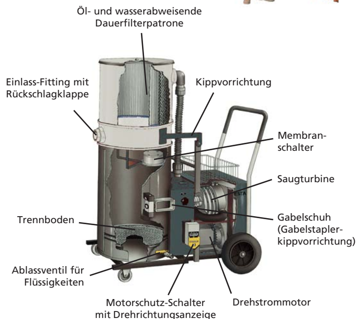
Absaugung von Spänen und Emulsionen an einem CNC-Fräszentrum
