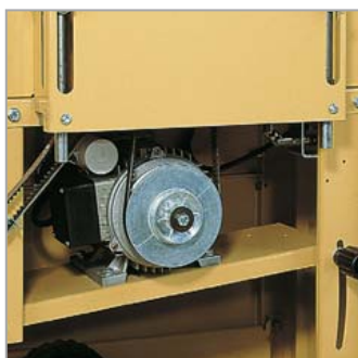
Hobelmaschine und Anbaugerät laufen getrennt jeweils über einen stark belastbaren Riemen-Antrieb
