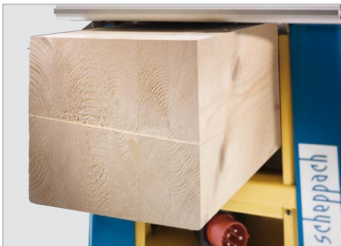
Durchlasshöhe /-breite beim Dickenhobeln: 250 x 210 mm
